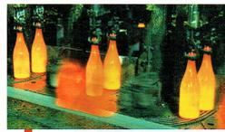
Fig. 6 Mise en forme de bouteilles en verre.
