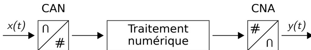
Le passage d'un signal analogique à un signal numérique se fait par l'intermédiaire d'un convertisseur analogique-numérique (CAN ou ADC) tel qu'un convertisseur flash par exemple. On va voir dans la première partie de l'exposé comment faire cette conversion en commençant par les critères d'échantillonnage, la quantification, puis une analyse spectrale pour voir les effets de la numérisation sur le signal.
